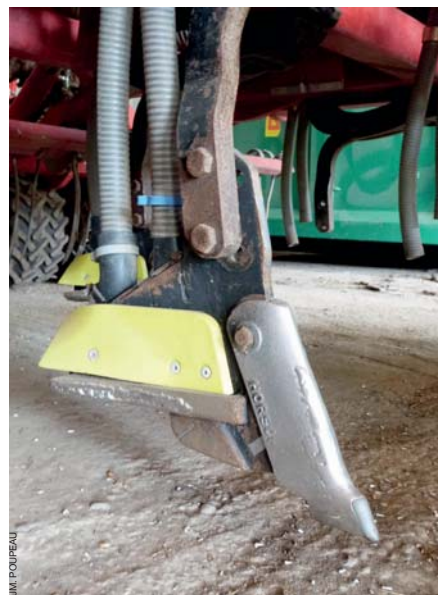
La double distribution du Horsch Sprinter permet de semer des cultures en association mais aussi d'apporter des engrais en localisé.
