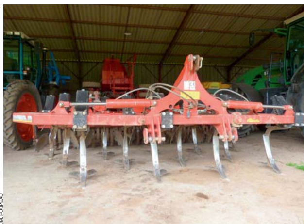
Un Horsch Terrano de 4 m est utilisé pour les travaux de déchaumage et préparation superficielle des terres.
