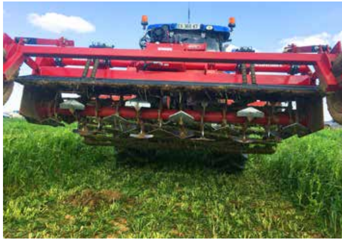
La fraise utilisée par Dominique et Vincent Rimette est montée sur un rouleau barre à l'avant et des roues de jauge à l'arrière afin d'ajuster précisément la profondeur de travail. ©V. Rimette
