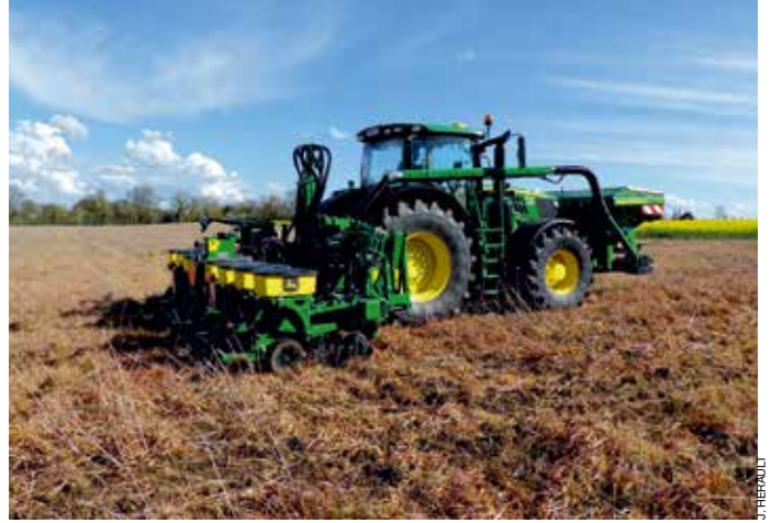
Le choix du chasse-débris impacte autant la qualité du sillon que la stabilité de l'élément semeur.
