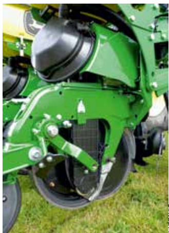
Lorsque la vitesse relative du lâcher de graine est identique à la vitesse d'avancement avec des pointes de semis en V, les éléments de plombage sont facultatifs.
