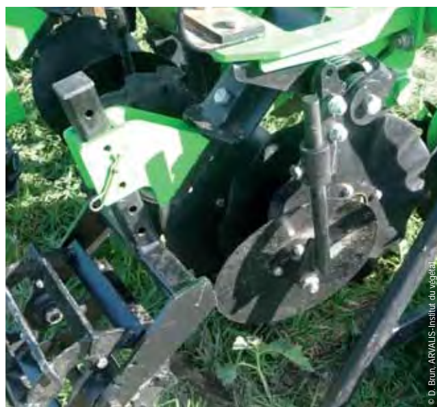
Avant le semis de la culture au printemps en sols argileux, le strip-tiller peut être équipé d'éléments de reprise superficielle : ici, des disques gauffrés.
