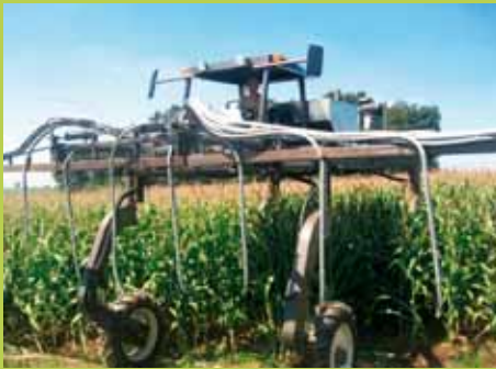
Enjambeur construit par C. Martin spécifiquement pour implanter les couverts sur maïs grain en fin de cycle. Une activité qu'il espère développer en tant qu'entrepreneur de travaux agricole s'il arrive à maîtriser et à sécuriser ce mode d'implantation.
