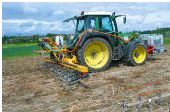
Une nouvelle technique d'épandage des engrais minéraux pourrait se propager à l'avenir : le procédé Cultan (Controlled Uptake Long Term Ammonia Nutrition). Il s'agit d'injecter dans le sol une solution azotée concentrée (sulfate d'ammonium), formant un dépôt que les plantes peuvent absorber selon leurs besoins. Cette méthode devrait permettre de diminuer les pertes par lessivage de nitrates et ainsi avoir un effet positif sur la qualité des eaux. En outre, c'est un engrais de recyclage provenant d'une station de traitement des eaux usées, voire de l'industrie.
