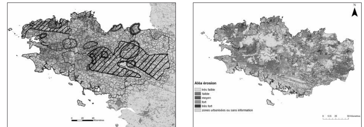
Figure 5. Estimation de l'aléa érosion en Bretagne. A. Analyse par des experts régionaux de la carte d'estimation de l'aléa d'érosion des sols issue du modèle national MESALES : (i) en rouge, surestimation ; (ii) en vert, sous-estimation ; (iii) en hachures noires, hétérogénéité exagérée. B. Résultat obtenu suite à l'amélioration des données d'entrée du modèle MESALES (Colmar et al., 2010)
