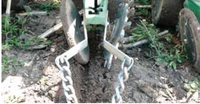
Les roues de fermeture à doigts Martin, avec un peu de pression, préparent bien le lit de semence et sécurisent la qualité de l'implantation, quelques heures à quelques jours ensuite.
