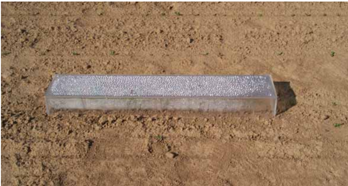
Figure 3. Essai chicorée 2005. Vue du dispositif employé pour récupérer l'eau dégagée par évaporation à la surface du sol.
