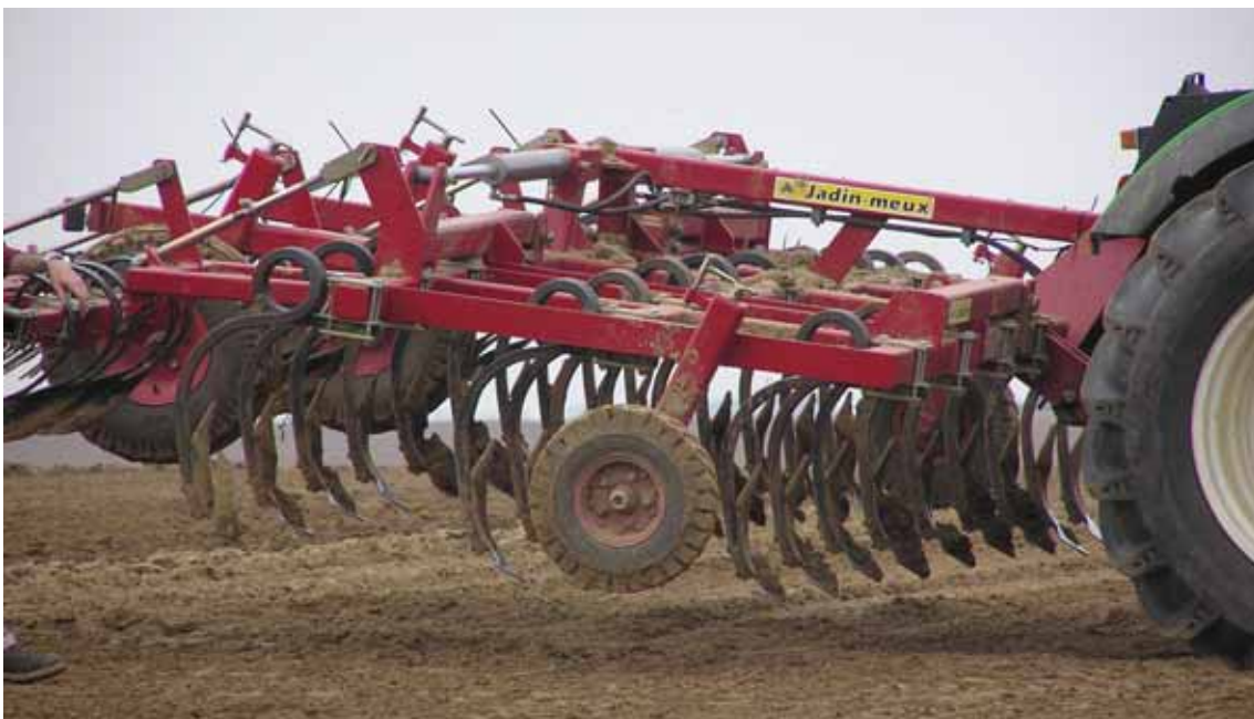
Figure 2. Vue du vibroculteur utilisé en TCS dans les essais.
