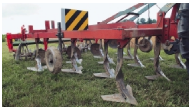
Fig. 3a. Le cultivateur à dents rigides, munies de socs à ailettes relativement plates, réalise un ameublissement efficace et homogène de la terre à profondeur moyenne.
