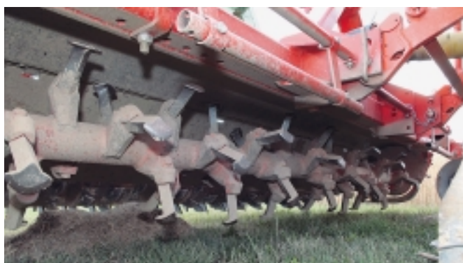
Fig. 4a. La herse rotative est une des machines permettant de réaliser le «travail minimum» du sol. Le semoir y est généralement directement accouplé; le semis est ainsi simultané.
