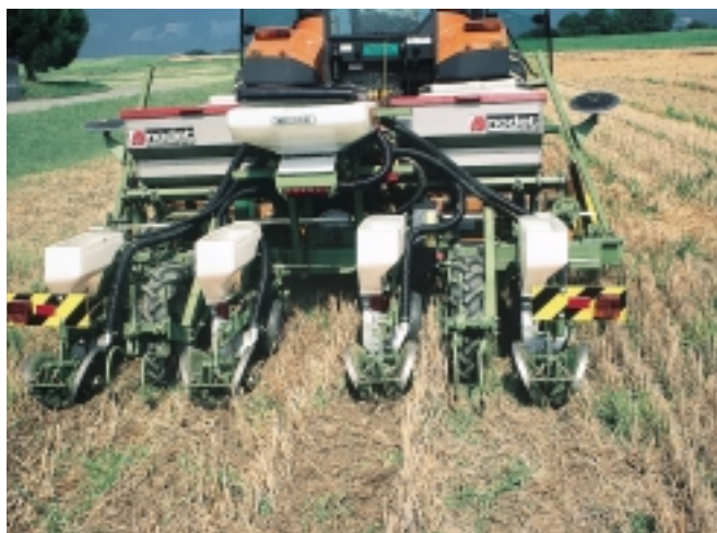
Fig. 6. Le semis en bandes fraîsées est une manière d'implanter le maïs par un travail du sol minimum sur moins de la moitié de la surface. C'est une technique intermédiaire entre le travail minimum du sol (sur toute la surface) et le semis direct. Comme ce dernier, il exige du doigté pour le désherbage.
