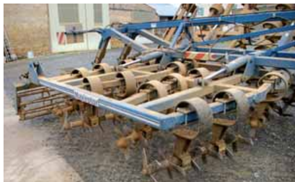
Maxirotor de chez Bonnel : les bèches roulantes montées sur lame-ressort permettent un travail en « coup de cuiller » qui diffère de celui d'un disque ou d'une dent. Patrice Mialon estime que c'est l'outil idéal de reprise au printemps dans une végétation verte : il n'a pas le défaut lissant du disque en conditions humides, ni l'effet « râtelier » de la dent.
