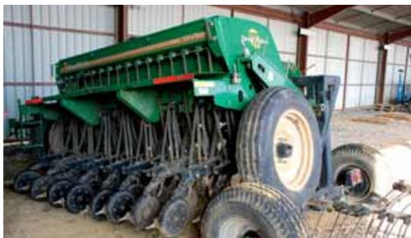
Le Great Plains se montre adapté aux pentes des coteaux grâce à son bon comportement en dévers. Les agriculteurs travaillent les pentes en travers en raison de la configuration des champs, mais aussi pour diminuer la puissance de traction nécessaire.
