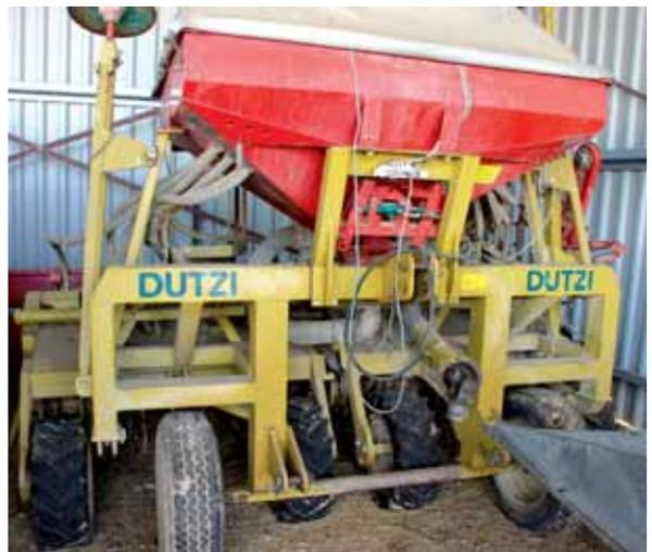
Le Dutzi KS possède des rotors qui permettent de débouvrer les dents du semoir. Toutefois, s'il s'avérait suffisant dans les rotations de types maïs-soja-blé, l'évacuation des résidus de maïs suite à la simplification de la rotation en « maïs-blé » s'est montrée plus difficile, justifiant le passage au Great Plains muni d'un disque ouvreur pour positionner la graine dans les résidus.
