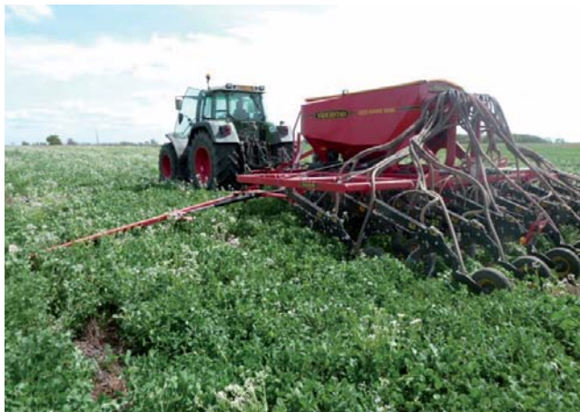
Le Seed Hawk de V. Baron a aujourd'hui une allure un peu étrange avec ses disques qui partent dans tous les sens. Cette astuce lui confère cependant un gain de polyvalence qu'apprécie aujourd'hui l'agriculteur.
