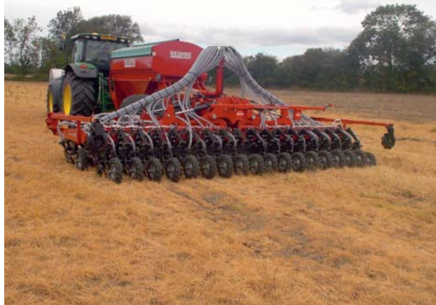
Le semoir GD6000 est disponible en version traînée avec une trémie de 5 t.
