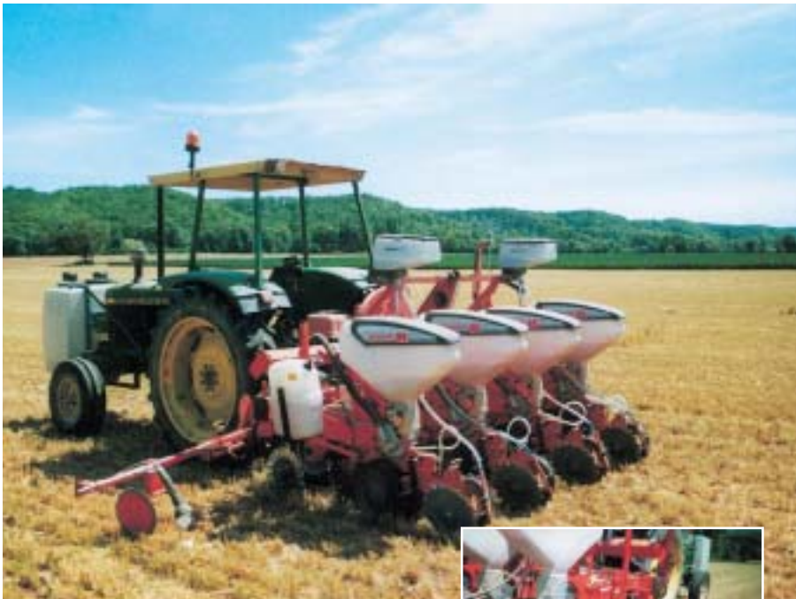
Semoir Sola Prosem au travail. Sa légèreté et son faible degré d'ouverture lui ont permis de détrôner tous ses concurrents dans les conditions de sols de l'exploitation, y compris le prototype construit par Christian Abadie lui-même.
