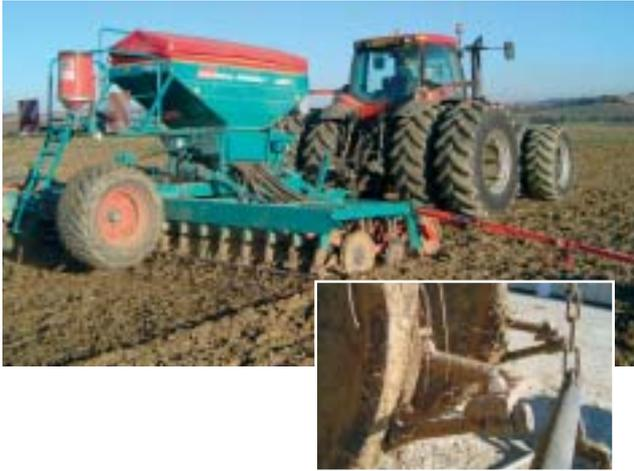
**Unidrill W6000 Tandem de Sulky : le semoir a été choisi pour sa capacité à travailler dans les couverts végétaux, l'accès facile et rapide aux éléments semeurs pour les réglages et les nettoyages, mais aussi par la configuration tandem permettant une meilleure répartition du poids sur les éléments semeurs. Sur la photo en médaillon, on peut voir les boulons qui ont remplacé les lames décroisseurs d'origine.**
