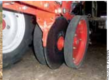
Montage des roues de jauge d'origine Kuhn à l'envers afin de les éloigner des disques.
