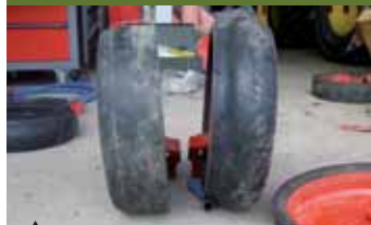
Présentation de la différence entre les pneus classiques (à gauche) montés sur la grande majorité des semoirs et les pneus de type « Martin » où l'appui et la pression sont suffisamment éloignés des disques ouvreurs pour éviter ce pincement entre disque et roue qui entraîne inévitablement une compaction des bordures du sillon et rend plus difficile la fermeture de la ligne de semis. Trop souvent la solution a été d'augmenter la pression à l'arrière ce qui, dans beaucoup de cas, permet de refermer le sillon mais peut accentuer l'isolement des graines et ralentir la levée, alors qu'il est simple d'éviter de créer le problème en amont avec cette astuce tout en limitant la pression sur les éléments semeurs.
