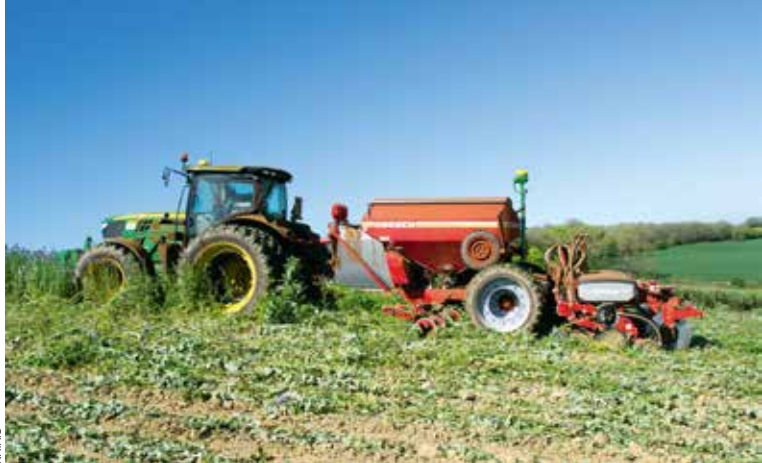
Semis du maïs dans le couvert vivant avec destruction mécanique et positionnement d'engrais dans la ligne de semis.
