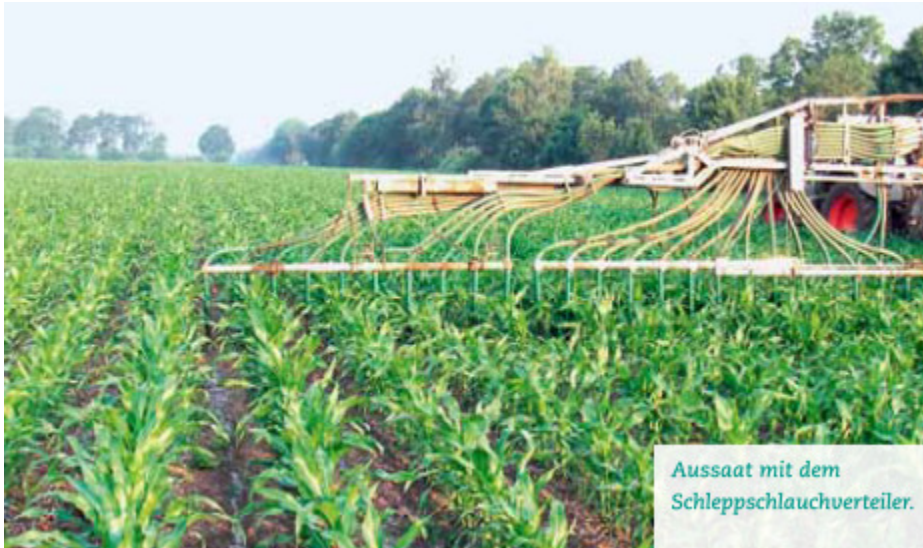
Beim Befüllen des Güllefasses entsteht ein Unterdruck im dünnen Schlauch, der das Saatgut ansaugt.
