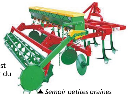
▲ Semoir petites graines monté sur un déchaumeur à dents
