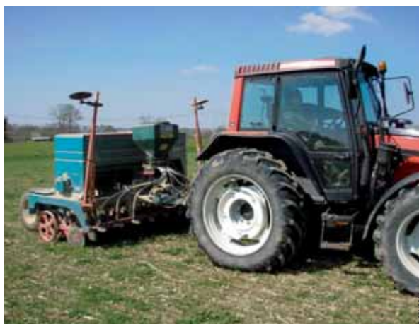
La version prairie du semoir Unidril est équipée de lignes plus serrées ainsi que d'un semoir centrifuge Delimbe. Les disques assurent un travail suffisant pour pouvoir semer les céréales ou les trèfles à la volée et le reste dans la caisse de semis.
