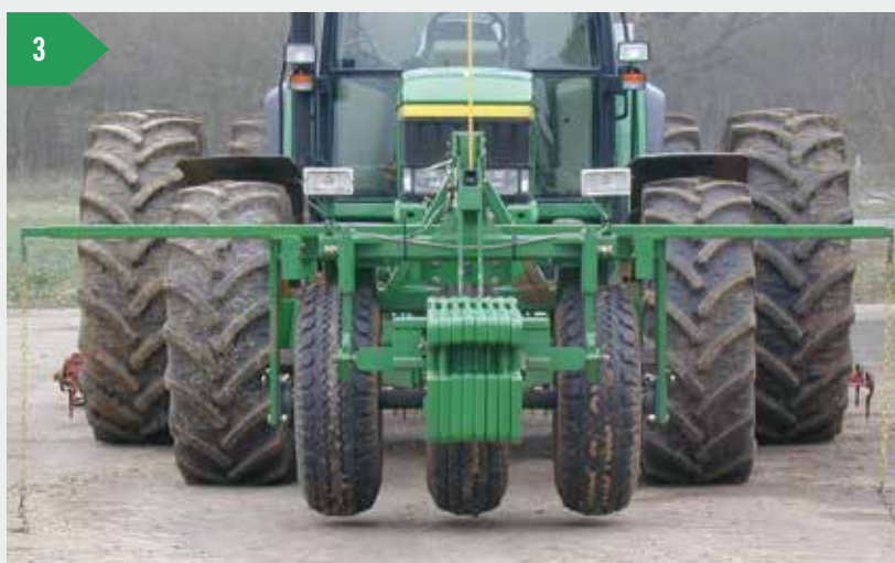
3 L'équipement complet jumelage et tasse-avant répartit les poids sur toute la largeur de travail et limite les risques de tassement.
