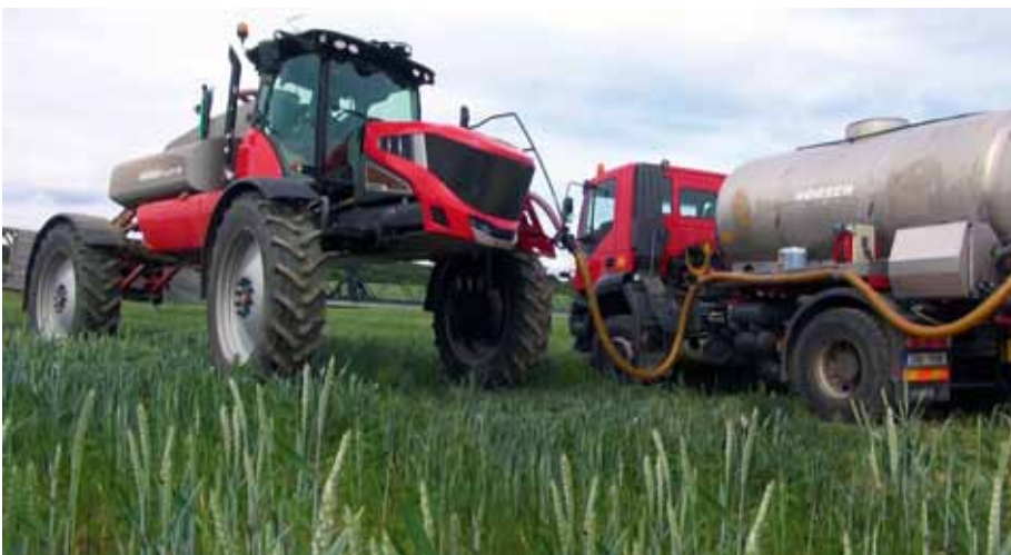
Remplissage du PT 330 – avec 5 000 litres pour traiter 50 à 80 ha, à 25 km/h – en moins de 3 minutes.
