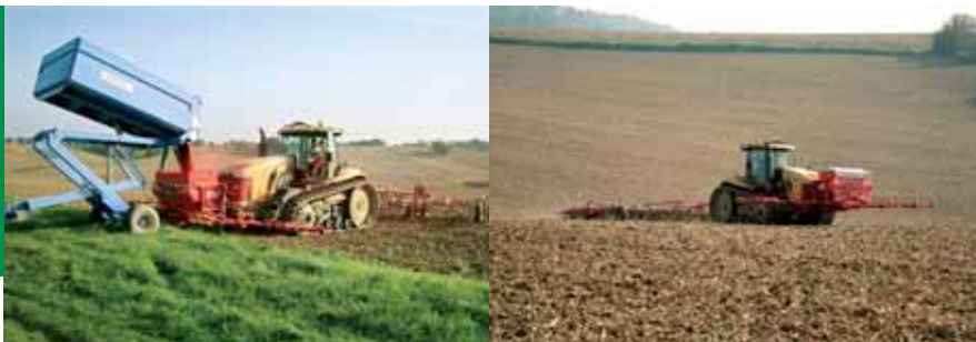
ÉRIC DELMOTTE SÈME SES BLÉS DE MAÏS GRAIN À LA VOLÉE DEPUIS DEUX ANS. Il utilise pour cela à l'avant du tracteur un semoir pneumatique Khun équipé d'une rampe de 10 m. À l'arrière, il recouvre les grains avec un vibroculteur Kongskilde où les dents ont été espacées à 17 cm pour éviter les bourrages dans les résidus. L'outil est également équipé d'une herse peigne avec deux premières rangées de gros peignes pour gérer les travaux grossiers et trois rangées arrières de petits peignes qui affinent le travail. Pour l'agriculteur du Lot-et-Garonne, cet outil est intéressant car relativement « agressif » ; qualité requise lorsque le sol a été un peu rappuyé entre le déchaumage (au Vario de Kockerling) et le semis.
