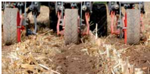
Le Striger dégage et n'ouvre qu'une bande de quelques centimètres, et les disques latéraux conservent bien la terre afin de faciliter le semis et l'implantation rapide de la culture.
