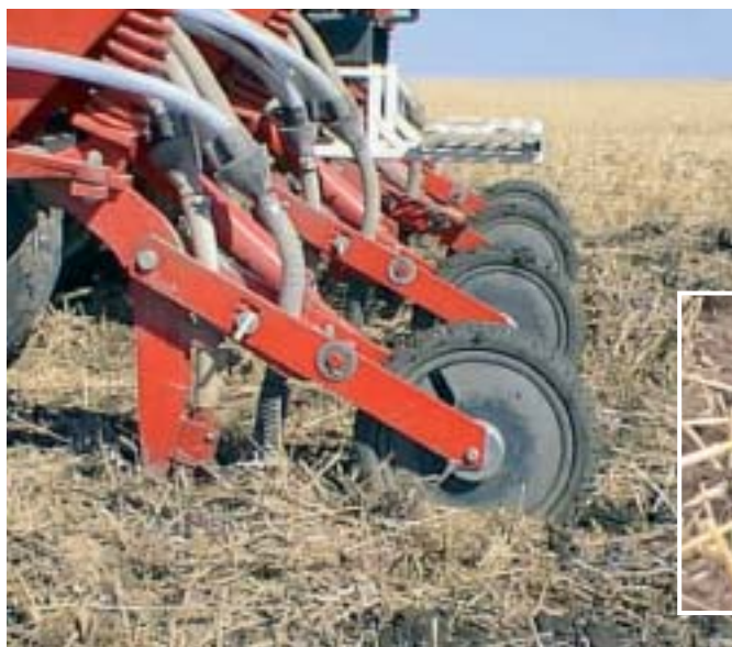
Dents de Conserva-pack : l'engrais est positionné en profondeur (5 à 6 cm) et la graine sur une « marche » taillée sur le rebord du sillon, réalisée par une seconde pointe qui suit la première.
